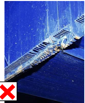
Kuva 13: Ei sallittu! Tämän palkin sydänkärjet ovat pahasti vääntyneet ja koskettavat toisiinsa
