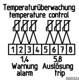
Schéma 3 Exemple d'affectation des bornes pour une version standard de la surveillance de la thermique
