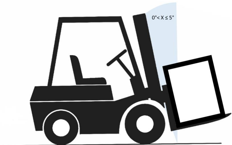
9. ábra: Dőlésszög a villás targoncával való szállításnál
