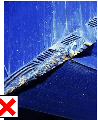
13. ábra: Nem engedélyezett! Ennek a keresztfejnek a magcsúcsai erősen elhajlottak és érintkeznek egymással
