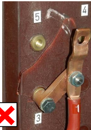
12. ábra: Nem engedélyezett! A felület szétforgácsolódása a kapcsoló-összekötőre kifejtett erőszakos erőhatás következtében
